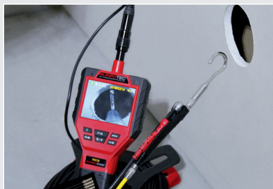
Hohlwand-inspektion Suchen und Einfangen
