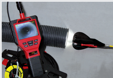
Rohr-inspektion für große Rohrdurchmesser
